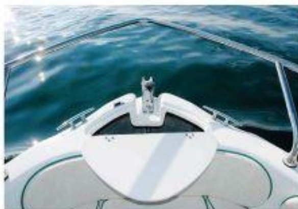
Ankerkasten, Ankerroller, Bugklampen und Bugreling sind Bestandteile des Standardequipments
