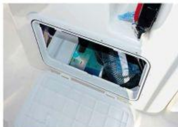
Jeder Raum ist genutzt: Unser Bild zeigt ein spritzwassergeschütztes Staufach im Inneren der Steuerkonsole
